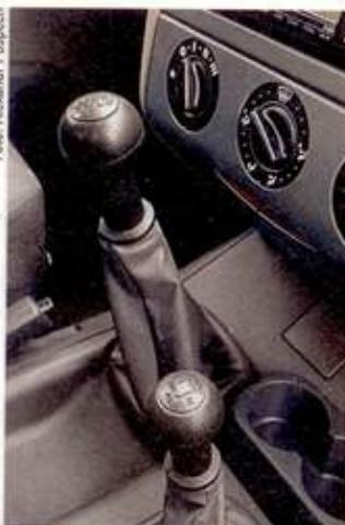
**KLASICKÉ PÁKY** řazení a ovládání pohonu. Nechybí redukční převodovka, celý systém vyžaduje pevnou ruku.
