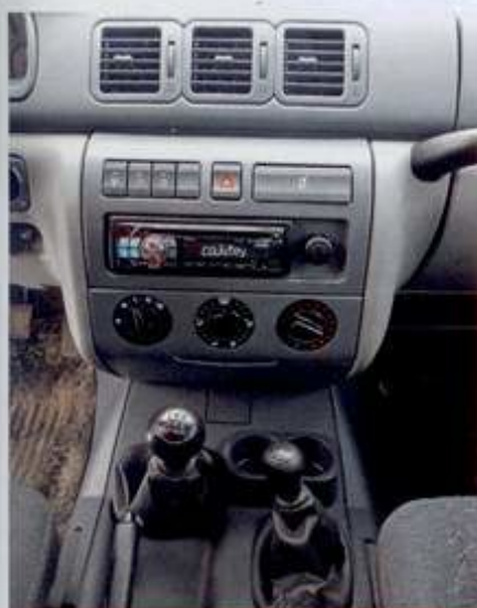
K trvale poháněné zadní nápravě lze připojit pohon předních kol, resp. redukcí
